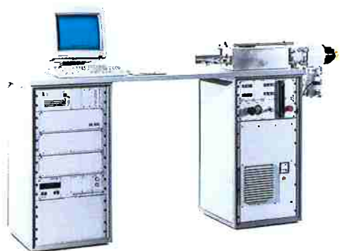
Figura 2.1 – Vista do dilatômetro Bähr com sistema de tratamento de dados.
