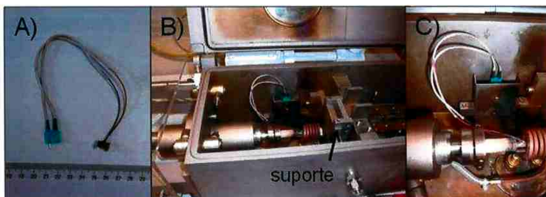
Figura 2.2 – A) Amostra do dilatômetro com par de termopares S e pratos de molibdênio, prepara para o ensaio; B) Vista de dentro do dilatômetro com amostra colocada e termopar ligado; C) Amostra no dilatômetro, antes do suporte ser retirado e amostra ficar envolvida pelo forno.
